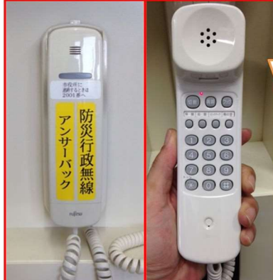
防災行政無線アンサーバック
