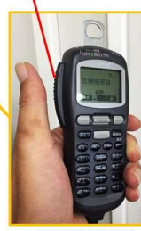
無線機に接続されているマイク
