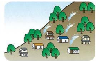
③斜面から水が噴き出す
